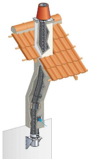
Figure 3 – Installation dans un conduit existant
